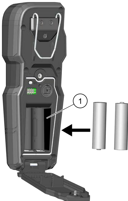
Figure 1. Installation des piles de la télécommande
